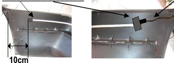
C- Después de conectar el sensor antena, puede comenzar a aplicar la cinta en el parachoques aplicando una fuerte presión para que se adhiera bien a su superficie interna. Después de la aplicación, se puede cortar el exceso de cinta.
